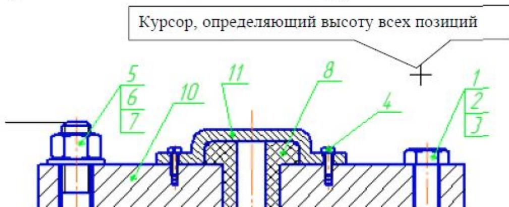
7. Создание спецификации и подключение к ней сборочного чертежа.
